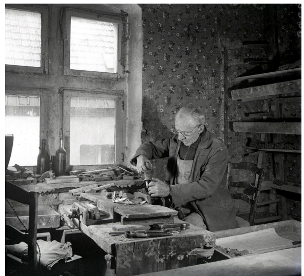
Afb. 6. Het kasten van een pijp door de pijpenmaker Levêque.
