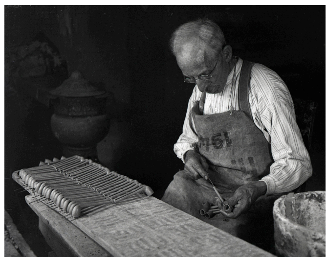
Afb. 7. De pijpenmaker Levêque prikt het rookkanaal door.
